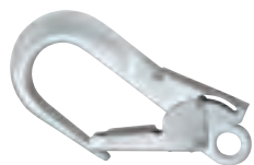
553 69 MAXITUBE KARABINER, EN 362: SZÉLESSÉG: 60 MM MINIMUM TÖRÉSI ERŐ: 22 KN
